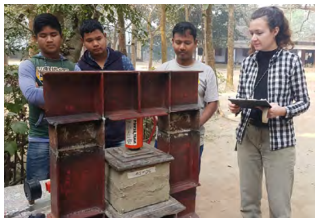
Christina Jötten bei der Druckfestigkeitsprüfung der Bausteine
